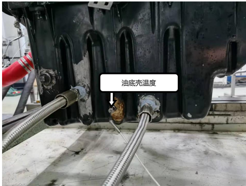
图B.18 油底壳温度测量位置
