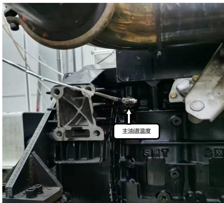
图B.16 主油道温度测量位置
