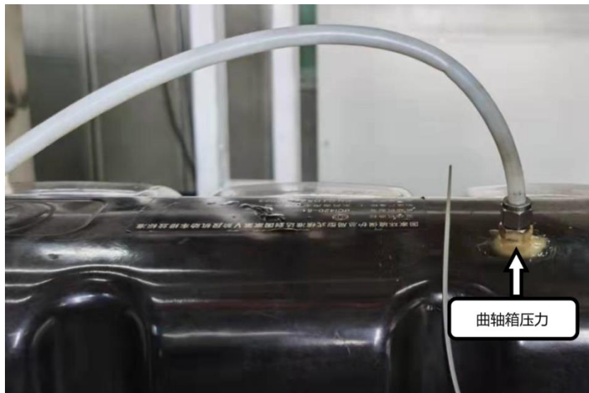
图 B.19 曲轴箱压力测量位置
