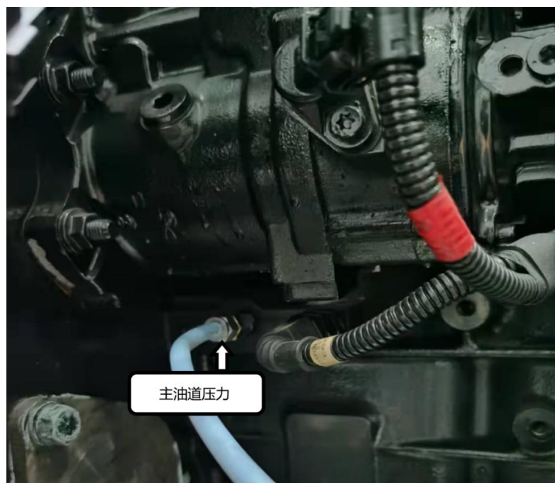
图B.15 主油道压力测量位置
