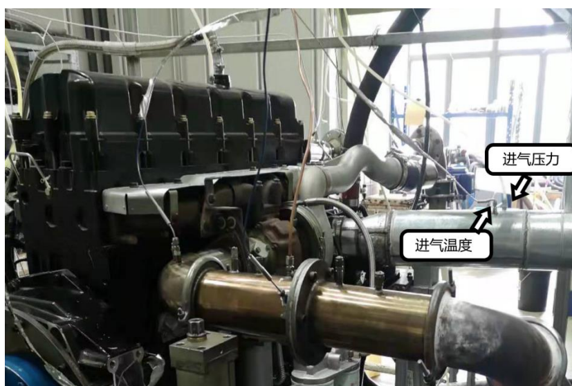
图 B.8 进气温度与压力测量位置
