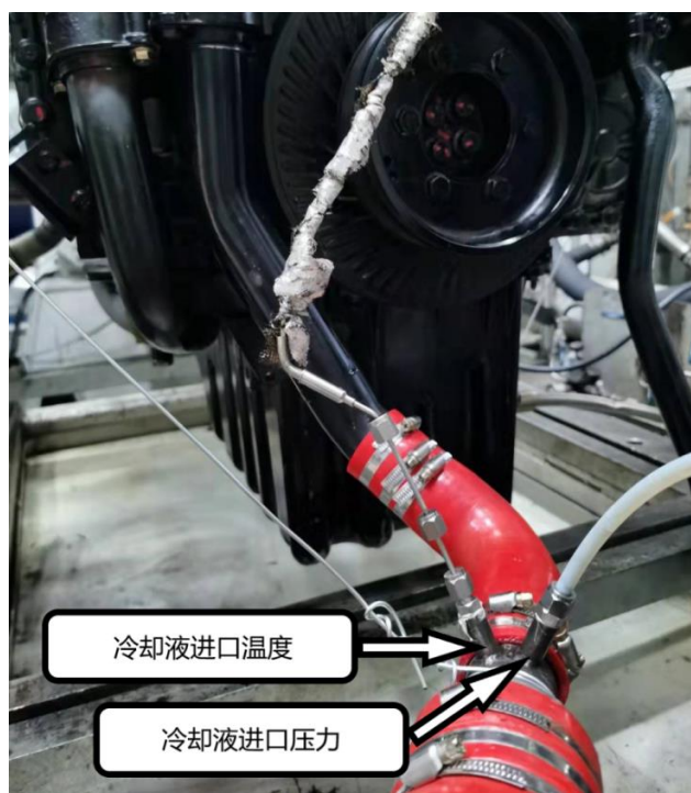
图B.14 冷却液进口温度与压力测量位置
