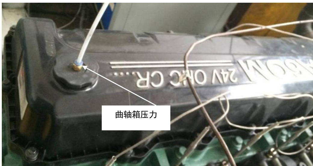
图B.14 曲轴箱压力测量位置
