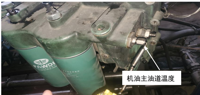
图 B.9 机油主油道温度测量
