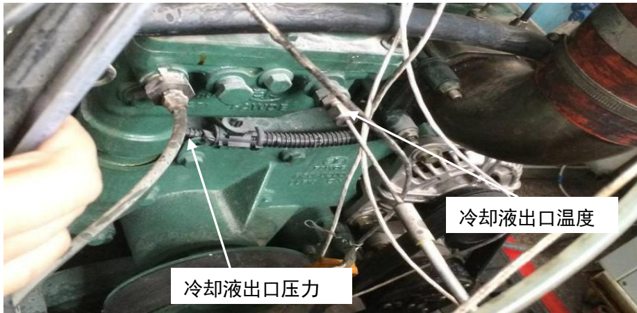
图 B.8 冷却液出口温度与压力测量位置
