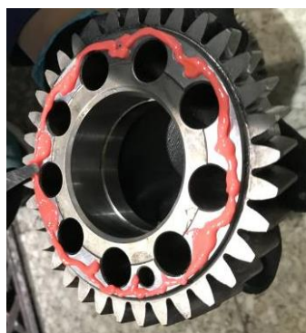
图3 曲轴正时齿轮涂胶
